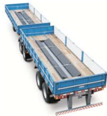
Interlink Semi-Trailer for Coil Transportation Bitren para el Transporte de Bobinas de Acero Semi-Remorque Bitrain Porte Bobines d'Acier
